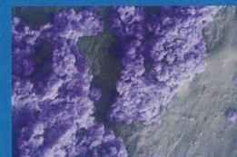
患者接触面から回収した DSB の SEM 画像 (倍率 10,000 倍)
