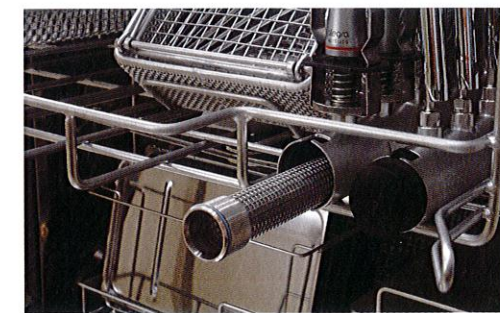
セントラルフィルターはキャップを取るだけで取り外し可能。
