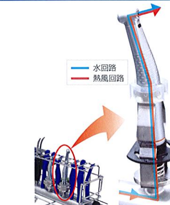
PG8591 の乾燥工程では、洗浄・消毒工程の際に水や熱水が通ったハンドピース内部の回路と同じ回路に 100℃ のホットエアが通ります。
